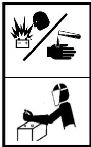
**ADVERTENCIA:** Las emanaciones de la batería son inflamables y pueden estallar. Mantenga lejos de la batería todos los materiales que se estén quemando. Una explosión de la batería puede causar ceguera. El ácido puede causar ceguera y quemaduras. Las herramientas y abrazaderas de los cables pueden soltar chispas.
