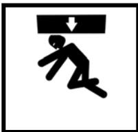
**ADVERTENCIA:** Las cargas elevadas pueden moverse o caerse. La caída de la carga puede aplastarlo o golpearlo y provocarle heridas graves o la muerte. No permita nunca que nadie trabaje por debajo de una carga levantada, a menos que esté adecuadamente apoyada para evitar que se mueva o se caiga.
